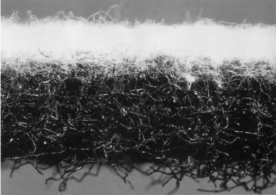
Abb. C 14: Detailaufnahme eines Vliesstoffes mit Stabilisierungsschicht
